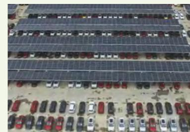
บริษัท เอสเอไอซี มอเตอร์ ซีพี จำกัด ติดตั้งระบบโซล่าเซลล์ไฟฟ้าจากพลังงานแสงอาทิตย์บนหลังคาที่จอดรถ (Solar Car Park) ขนาดใหญ่ที่สุดในประเทศไทย ครอบคลุมพื้นที่รวม 31,000 ตารางเมตร มีขนาดผลิตพลังงานไฟฟ้ารวม 4.88 เมกะวัตต์
